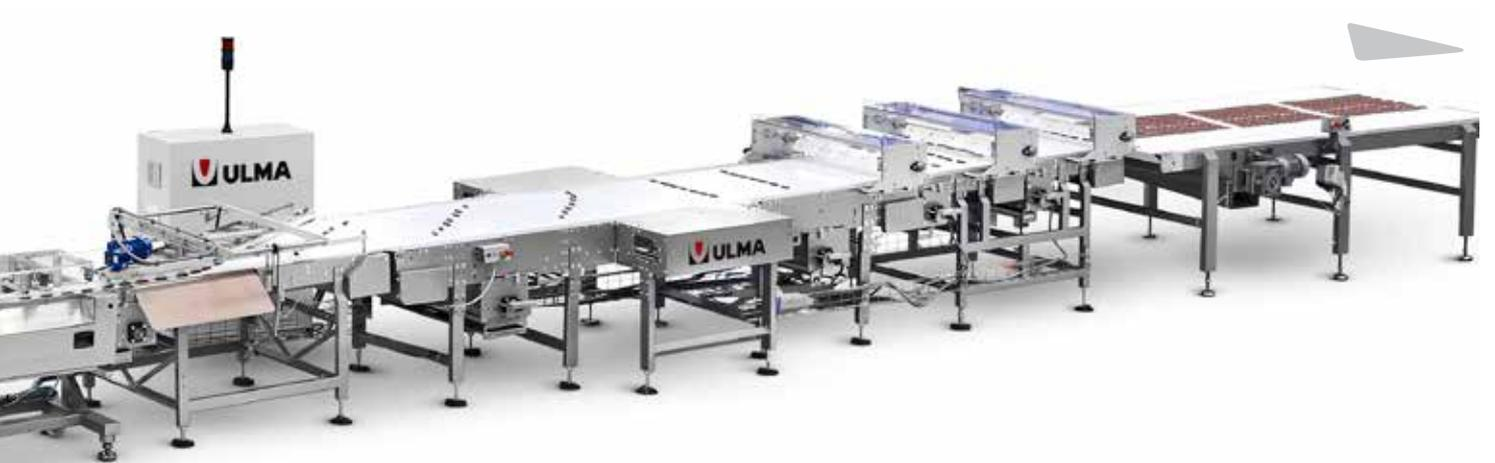
Les rangs de produit qui arrivent dans le tunnel de refroidissement sont étirés à l'aide d'un système à double bande en angle, ce qui rend plus facile l'alignement du produit, nécessaire pour son introduction dans le système d'alimentation automatique.
